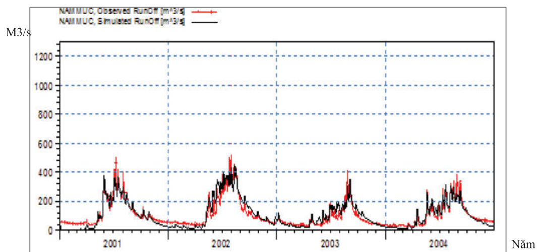
Hình 4: Quá trình lưu lượng thực đo và tính toán kiểm định mô hình (từ năm 2000 - 2010)
